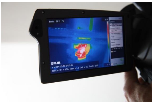
Zdjęcie 6. Kontrola szczelności rur ciśnieniowych przechodzących przez stropodach odprowadzających wodę z dachu
